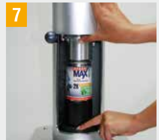
7 2K 250ml: Abfülladapter wird als Höhenausgleich bei der Abfüllung benötigt
